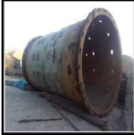
MONTAJE DE FORROS MOLINO 4' X 8' U.M CIEMSA
